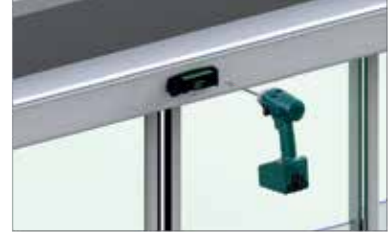
Radar alt kapak alüminyum profile vidalanır. / Crew motion detector bottom cover to aluminium profile.
